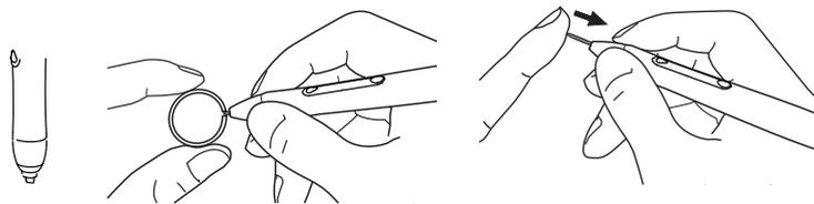
1. 用笔夹夹住笔尖向下夹出已经磨损的笔尖;
