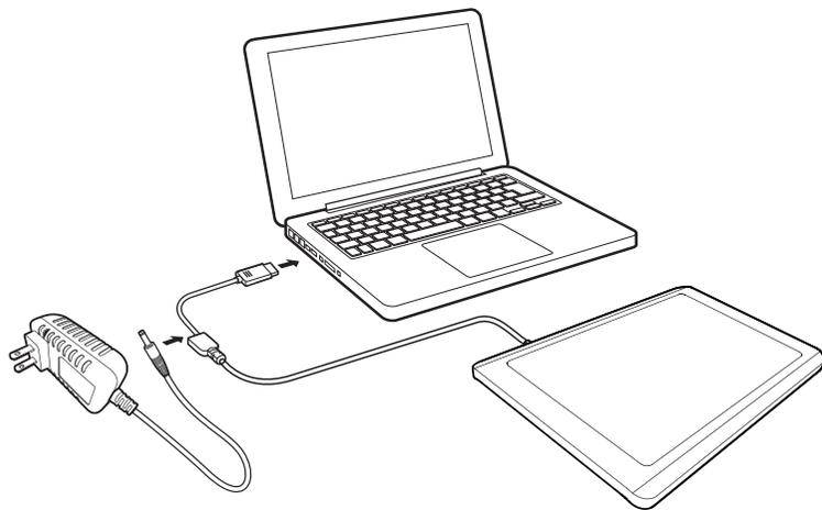
1. 将USB线缆的A端连接多功能手写屏设备，盖紧连接线保护舱以防止脱落；
